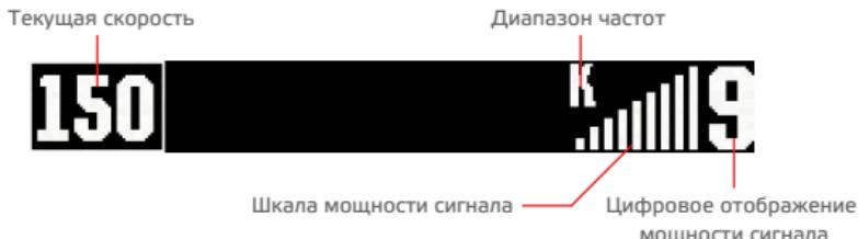
**3. При обнаружении точки GPS на дисплее отображается:**
